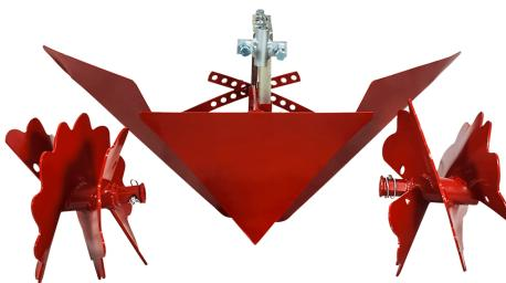
Por su diseño helicoidal, este acaballonador especial para realizar caballones de grandes dimensiones, remonta la tierra y acaballa al mismo tiempo. Esta compuesto por dos sifines que se montan directamente a los ejes de salida de la maquina y una reja con alas que se monta al soporte trasero.
