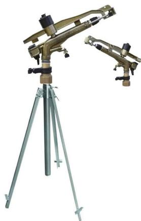
El Cañón de Riego DCR065 DUCAR 1.5" NPT Hembra Bronce tiene un cabezal de aspersión de alto rendimiento con capacidad de rotación de giro completo, pero también es ajustable al rango de ajustes de ángulo deseado. Es de tipo impacto y de presión media. Proporciona un riego óptimo con una distribución homogénea del agua gracias a las boquillas de aspersor intercambiables y el doble orificio de salida de agua. Apto para el riego de todo tipo de cultivos de campo y verduras.
