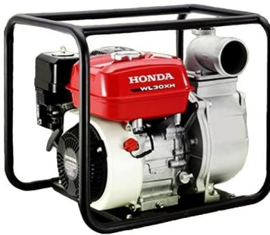
Motobomba WL30XM, 4 tiempos, autocebante descarga de 3", motor de 5.5hp altura de 23m semiprofesional
