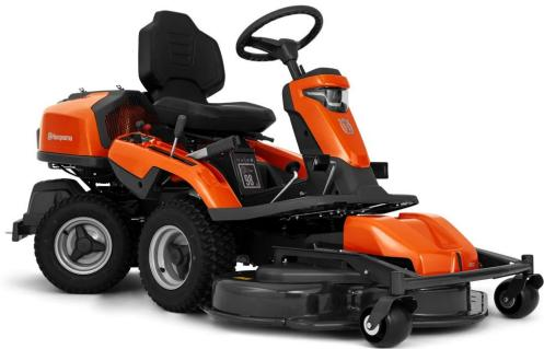
Tractopodador Rider R316TX Husqvarna 44", la dirección articulada ofrece una excelente maniobrabilidad y facilita la conducción alrededor de obstáculos como árboles y arbustos. Dado que el par de ruedas traseras puede girar por debajo de la máquina, el radio de giro se vuelve mínimo con el volante a tope.
