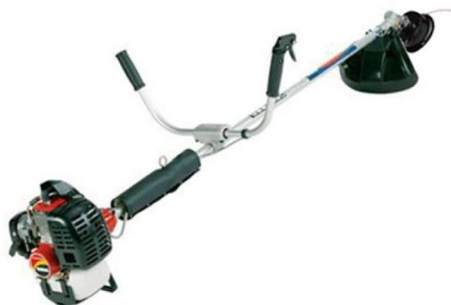
Desbrozadora Shindaiwa C35 motor 2 tiempos, cilindrada a 33.6cc, tubo recto con mango tipo V Longitud total 1.78m - Incluye Arnés y cabezal de hilo
