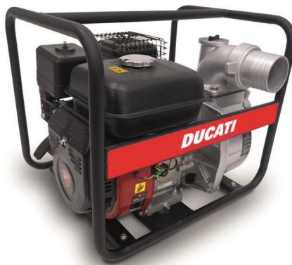
Motobomba Ducati autocebante, alta presión modelo DCW-80, motor 4 tiempos de 7hp, succión y descarga de 3", altura máxima de descarga de 28m.
