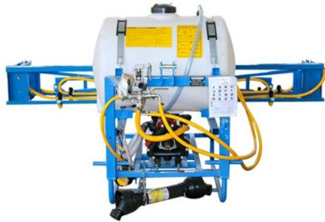
**Aspersora Swissmex Aguilón Ligero 668100** equipo Pony, diseñado para realizar aplicaciones en espacios reducidos, como en cultivo protegido e intensivo. Tanque en polietileno de alta densidad con inhibidor de rayos UV. Chasis de acero estructural recubierto con pintura epóxica horneada que lo protege de la corrosión.
