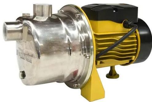
La Bomba de Agua Eléctrica JETS60 PARAZZINI es una elección confiable para tus necesidades de bombeo. Con un motor de 1/2 HP, esta bomba opera a 110 V y es capaz de proporcionar un caudal de 45 lpm y una altura máxima de 36 metros.
