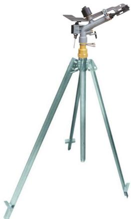
El cañón ATOM22 (DCR057) de la marca Ducar tiene un cabezal de aspersión de alto rendimiento con capacidad de rotación de giro completo, pero también es ajustable al rango de ajustes de ángulo deseado. Es de tipo impacto y de presión media. Proporciona un riego óptimo con una distribución homogénea del agua gracias a las boquillas de aspersor intercambiables y el doble orificio de salida de agua. Apto para el riego de todo tipo de cultivos de campo y verduras.
