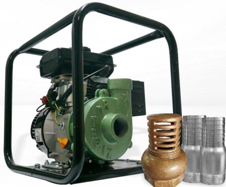
La **Antarix MC1.5UK2** es una motobomba centrífuga de alta eficiencia y fácil manejo. Está diseñada para aplicaciones agrícolas, industriales y domésticas. La MC1.5UK2 está **propulsada por un motor de gasolina** monocilíndrico de **4 tiempos** que es confiable y de bajo consumo. La bomba tiene una capacidad máxima de flujo de **315 litros por minuto** y una **altura máxima de cabeza de 38 metros**. La MC1.5UK2 es una bomba portátil y liviana que pesa solo **15 kilogramos**
