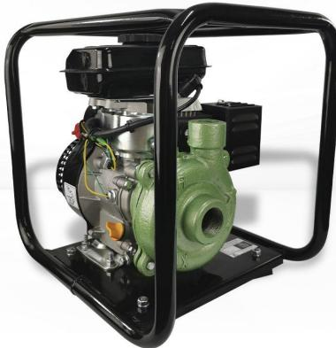
Motobomba centrífuga marca Antarix, cuenta con motor a gasolina de 4 tiempos, una potencia de 2.5 hp. La bomba tiene una capacidad máxima de flujo de 160 litros por minuto y una cabeza máxima de 42 metros.
