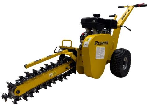
La **Zanjadora Parazzini** con **motor de 15 hp** con doble filtro puede usarse para una gran variedad de tareas que oscilarían entre trabajos de zanjado ligero y de alto rendimiento. Las profundidades de **excavación varían entre 20 cm y 60 cm**. El desplazamiento lateral le permite trabajar junto a muros o vallas.
